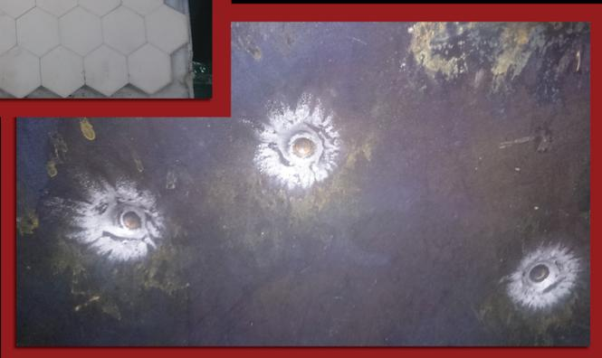
Razvili smo balističku zaštitu kombinovanu od polietilina (SVMPE) i keramičkih ploča koje su lakše od klasičnog balističkog čelika. Materijal ne koridira, odbija vlagu i ne sprovodi struju.
